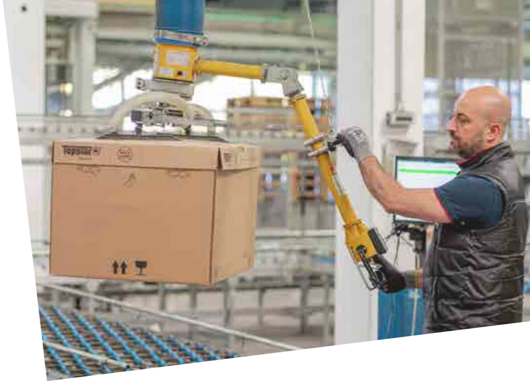
Vakuumheber im Sortierzentrum zur körperlichen Entlastung Vacuum lifters in the sorting centre for relief of physical strain
